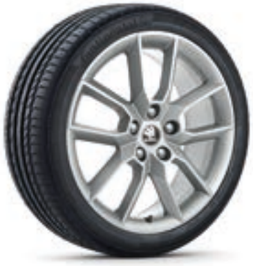
Gemini 5E0 071 498F 8Z8 Kolo z lehké slitiny 7,5J × 18" ET51 pro pneumatiky s rozměry 225/40 R18, ve stříbrné metalické barvě ŠKODA Originální příslušenství
