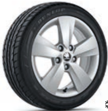
Tunga 5E0 071 496J 8Z8 Kolo z lehké slitiny 6J × 16" ET48 pro pneumatiky s rozměry 205/55 R16, ve stříbrné metalické barvě ŠKODA Originální příslušenství
