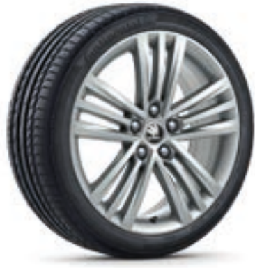
Trinity 3T0 071 498J 8Z8 Kolo z lehké slitiny 7,5J × 18" ET46 pro pneumatiky s rozměry 225/45 R18, ve stříbrné barvě (pouze OCTAVIA SCOUT) ŠKODA Originální příslušenství
