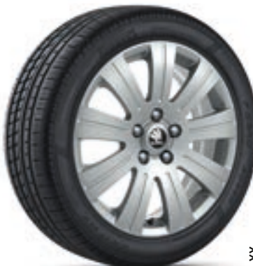
Flash 5EO 071 497B 7ZS Kolo z lehké slitiny 6J × 17" ET45 pro pneumatiky s rozměry 205/50 R17, ve stříbrné metalické barvě ŠKODA Originální příslušenství
