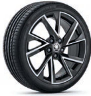
Vega 5E0 071 498N JX2 Kolo z lehké slitiny 7,5J × 18" ET51 pro pneumatiky s rozměry 225/40 R18, v černé lesklé barvě, broušené ŠKODA Originální příslušenství
